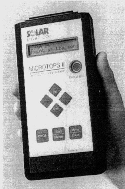
Fig: 2.2.1 MCROTOPS II Sunphotometer
